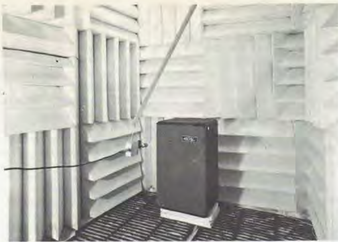
Camera anecoica con in esame il nuovo radiatore acustico Revac RA 100.
