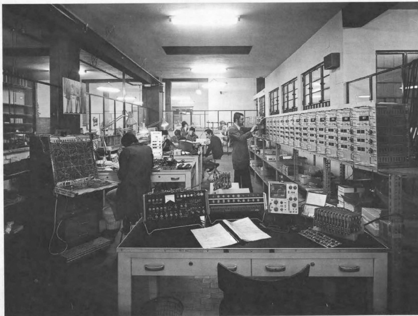
Sezione di produzione apparecchi industriali. Sulla sinistra si nota un simulatore per le prove di circuiti e sul tavolo in primo piano le attrezzature per il collaudo rapido e totale delle cartelle di circuiti stampati.
